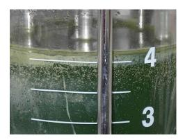
Abb. 5.23: Photobioreaktor (5 L) bei Anwendung von *P. vibrioformis* als Biokatalysator zur Produktion von biogenem S<sup>0</sup> aus Sulfid. An der Glaswand ist der abgelagerte biogene S<sup>0</sup> zu erkennen.
